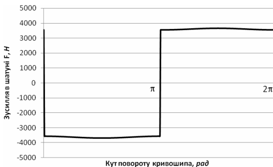
Рис. 5. Графік зміни зусилля в шатуні F в залежності від кута повороту кривошипа
