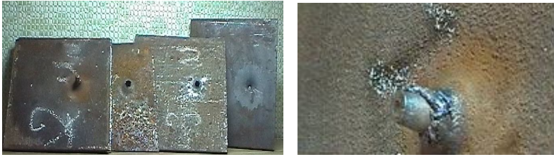
Рис. 3. Результати експериментальних досліджень по пробиттю металевих пластин з матеріалу Ст.3
